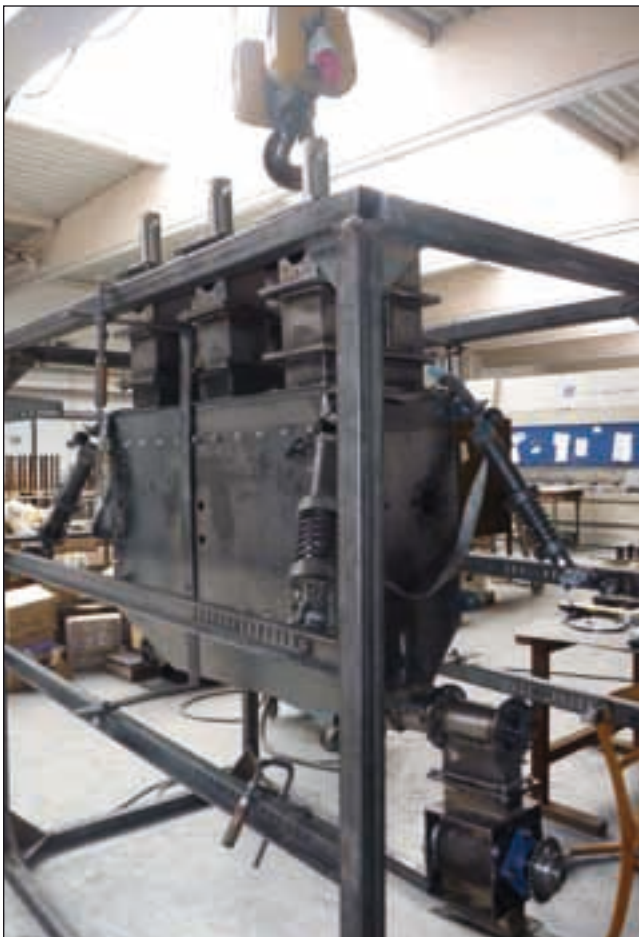
Prototyp eines Metallgewebefilters der neuen Generation für Holzgas von Innowatt-Energy
