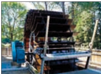
Altbewährtes Wasserrad (links) und ein neuer Ansatz zur Nutzung der Flusswasserkraft (rechts). Links: „Zuppinger Wasserrad“ aus dem 19. Jahrhundert bei Ulm (Quelle: Mühlbauer 2006). Rechts: Transport der Stromboje bei Wachau (Österreich). Quelle: Aqua Libre Energieentwicklungs GmbH (2007)
