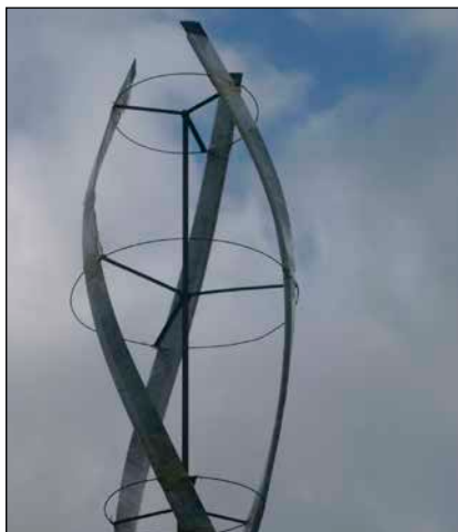
Bild 4: Ein Helix-Darrieus Marke Eigenkonstruktion: hier dürfte der Radius des Rotors gern größer sein (siehe Kasten)
