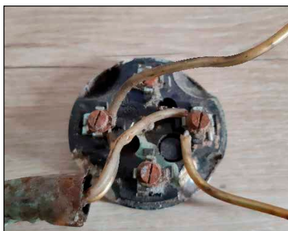
Bild 9: Worst Case-Schraubverbindungen in der HN-Verteilerdose
