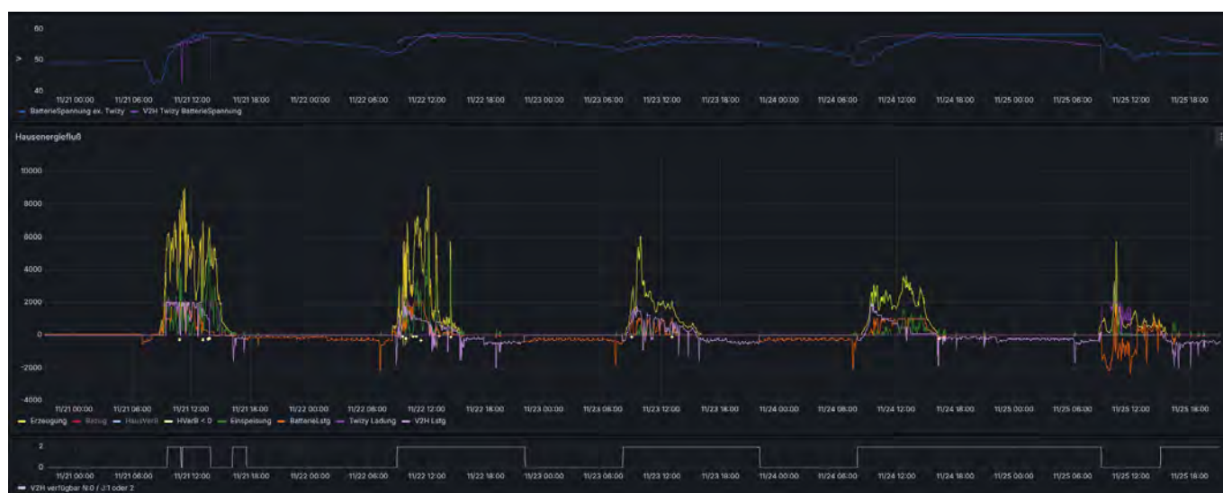
Energiefluss 21. bis 25. November – eine Phase mit V2H. Die Grafik zeigt Batteriespannungen, Energieflüsse, Netzbezug und Hausverbrauch an
