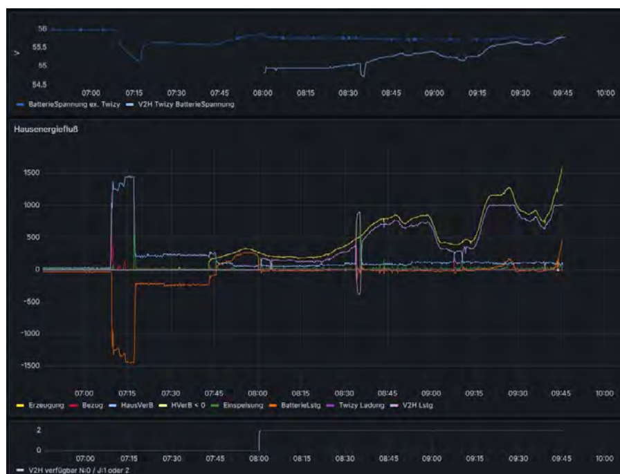
Energiefluss Morgendlicher Sonnenaufgang. Die orangefarbene Linie zeigt den Strombedarf aus dem Heimspeicher, die lilafarbene die Zuschaltung des E-Autos
